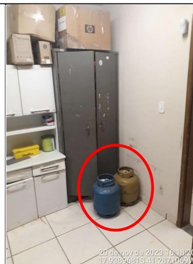
**Figura 16 – Detalhe de armazenamento indevido de dois botijões reservas de GLP**
