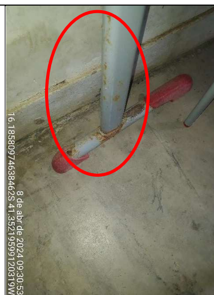
Figura 68 - Detalhe de ferrugem na cadeira da sala de aula
