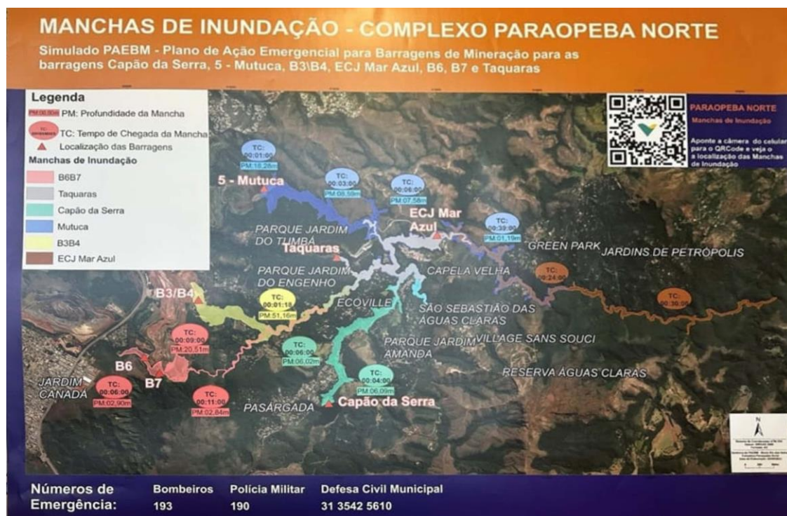
Figura 7 – Manchas de inundação Complexo Paraopeba Norte, afixados na Sala de Comando durante Simulado.
